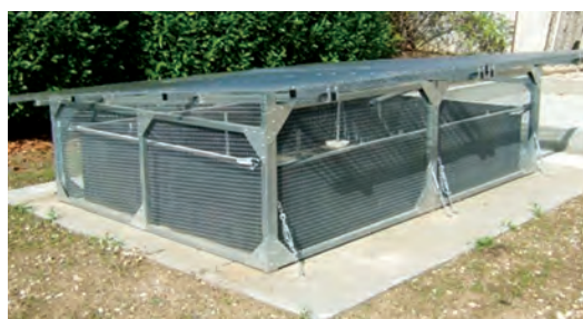
Figura 3. Sistema Heliosec para gestión de aguas con residuos de plaguicidas
