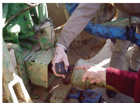
Figura 8. Medida de las revoluciones en la toma de fuerza con un tacómetro de mano
