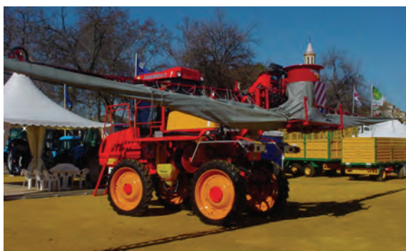
Figura 2. Pulverizador asistido por aire (zancudo)
