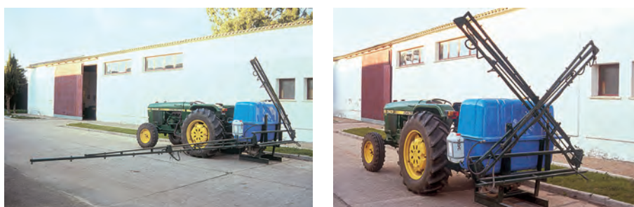
Figura 12. La barra portaboquillas debe plegarse para facilitar su transporte
