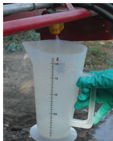
Figura 7. Medida del caudal suministrado por las boquillas de tratamiento
