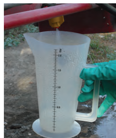
Figura 7. Medida del caudal de una boquilla
